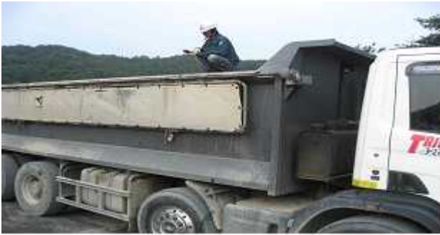
<그림 2> 운반장비에 상차된 아스팔트 혼합물의 온도 측정 전경
